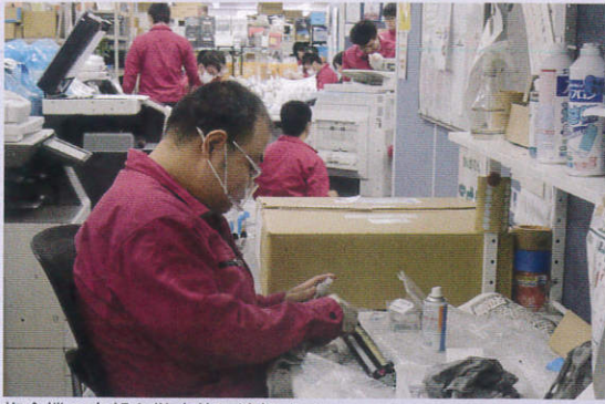
複合機の内部を徹底的に清掃する
